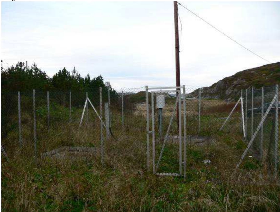
Urbanhydrologisk målestasjon i Karihola. Her måles korttidsnedbør, temperatur, snøsmelting og avrenning.
