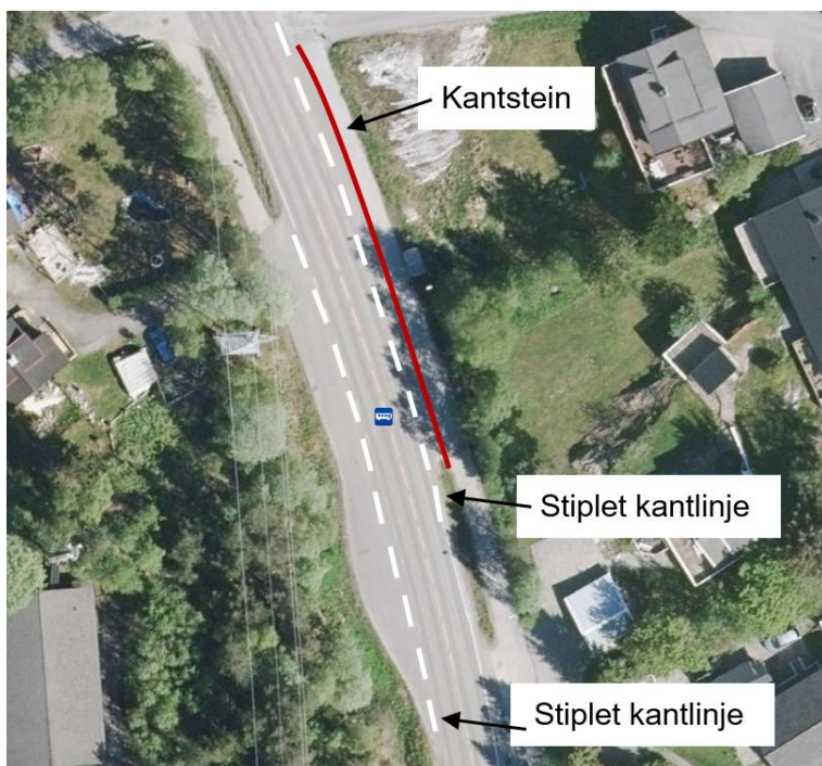
Figur 3-10: Tiltak ved bussholdeplass «Rensvikvatnet».
