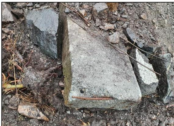
Figur 16: Betong med armering i massehaug.
