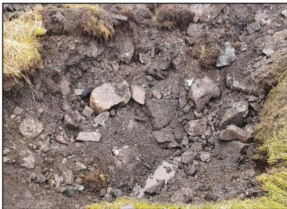
Figur 14: PG 5. Vegetasjonsdekke i topp. Innslag av tegl, trevirke og asfalt i massene. Innsig av sjøvann ved 1,5 m.
