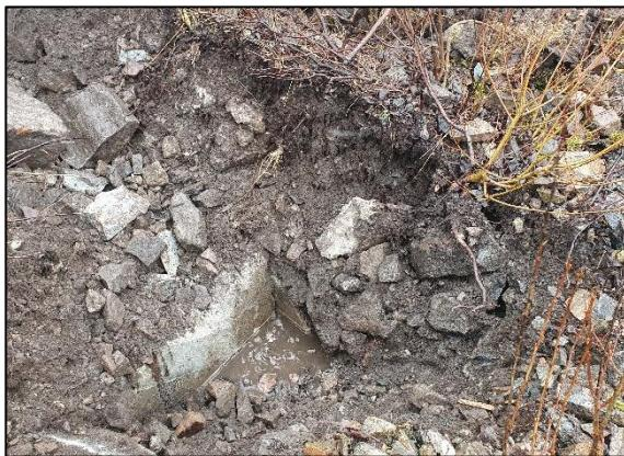
Figur 12: PG 1. Innslag av betong og avfall i massene. Innsig av sjøvann ved 1,5 m.
