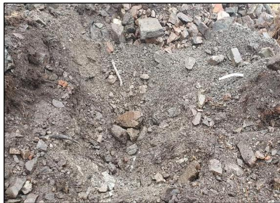
Figur 13: PG 4. Innslag av betong og avfall i massene. Stans i antatt fjell ved 1m.
