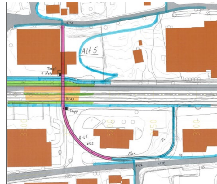
Figur 62. Forkastet gang- og sykkelbru på Løkkemyra. Brua ville blitt lang og alternativet ville fått uhensiktsmessige lange ramper.
