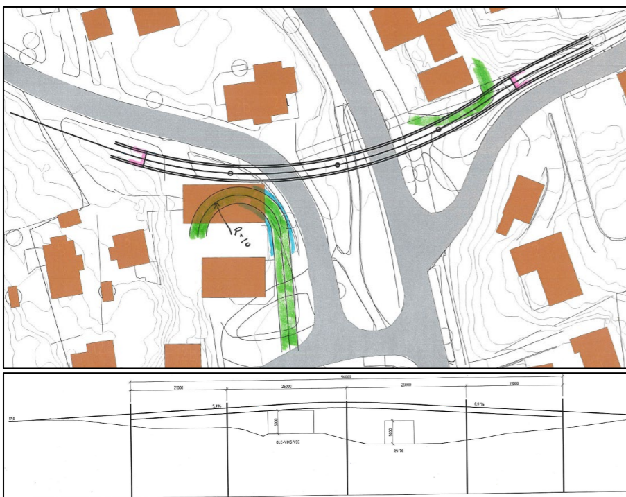
Figur 61. Plan- og snittegning av forkastet bru Persløkka–Ole Vigs gate.
