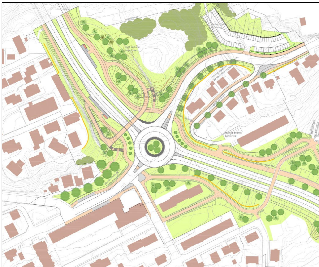
Figur 91. Illustrasjonen viser alternativ 2 veg i dagen over Kråkhaugen, med tilnærmede like løsning som for alternativ 1 med tunnel bortsett fra den sørøstlige vegarmen.
