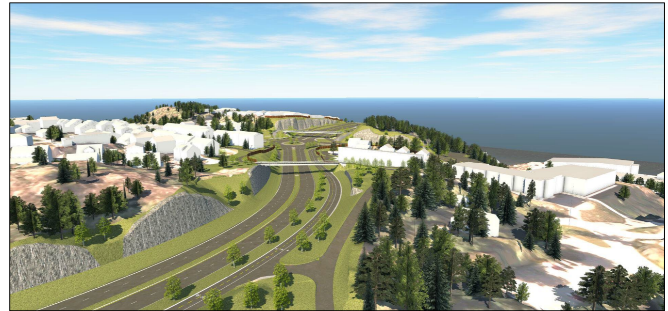
Figur 28. 3D-utsnitt med gang- og sykkelbru over rv. 70 øst for kontrollplassen alternativ 2 veg i dagen.
