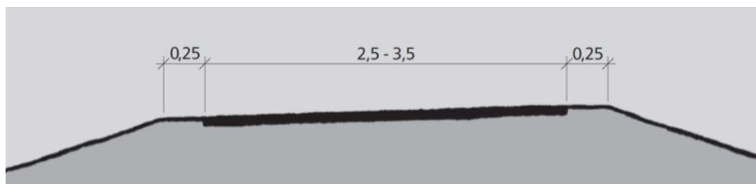
Figur 22 – Tverrprofil av gang- og sykkelveg med bredde 2,5–3,5 meter.
