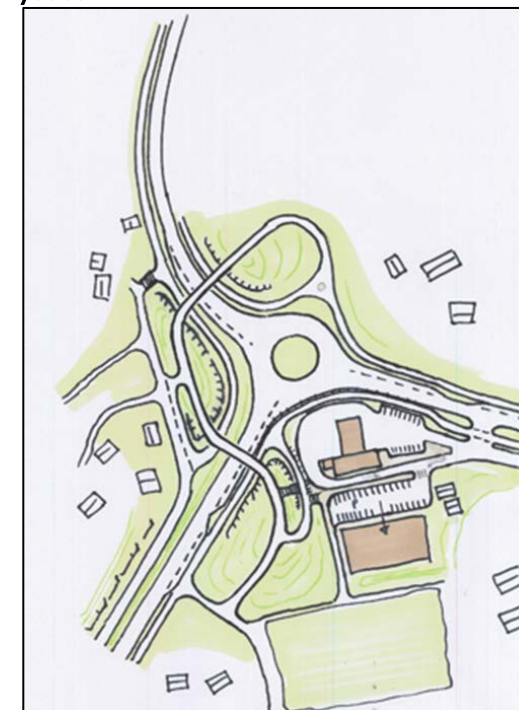
Figur 36 – Bro med to armer i Rensvikkrysset
