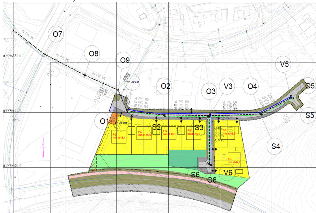
Figur 5 håndtering av overvann mot vest.
