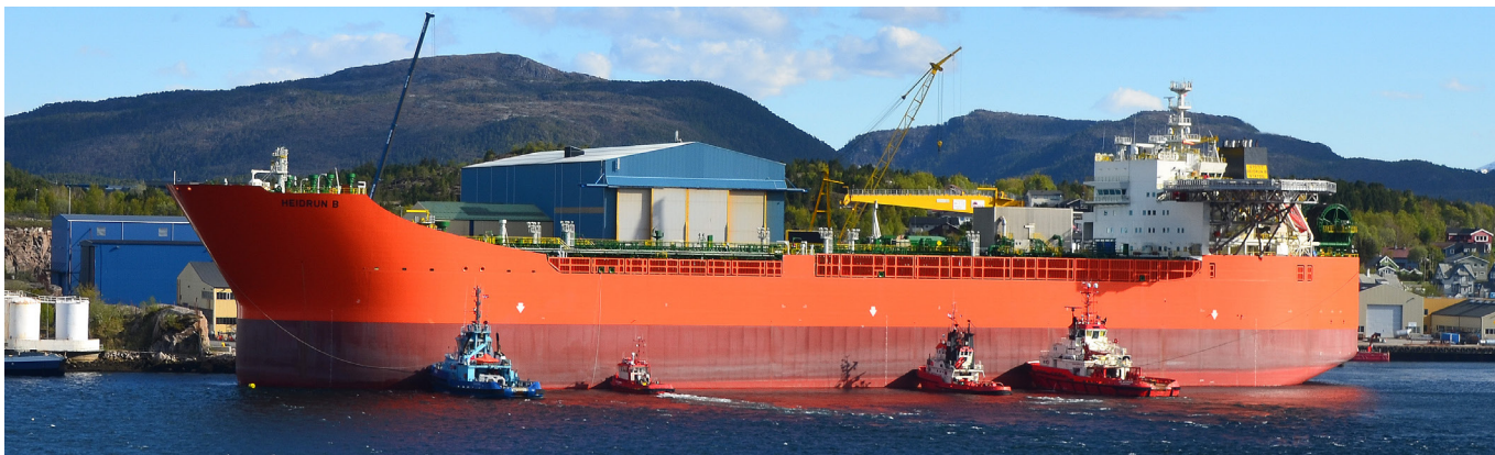
Heidrun B er ca 250 meter langt, 46 meter bredt og har en lastekapasitet på 850 000 fat olje
