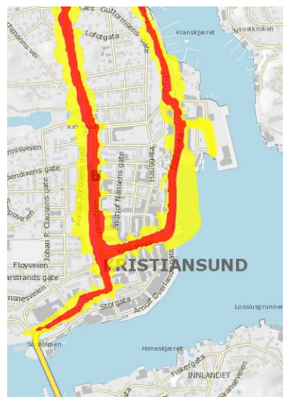
Figur 12 Støyvarselkart viser beregnede støyinnivåer for en prognosesituasjon, trafikkvolum (ÅDT) er fremskrevet til år 2035 (SVV)
