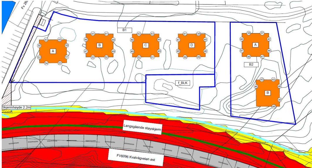
Figur 18: illustrasjon støysoner ved 2,2m støyskjerm og nivå 1,5m over bakken
