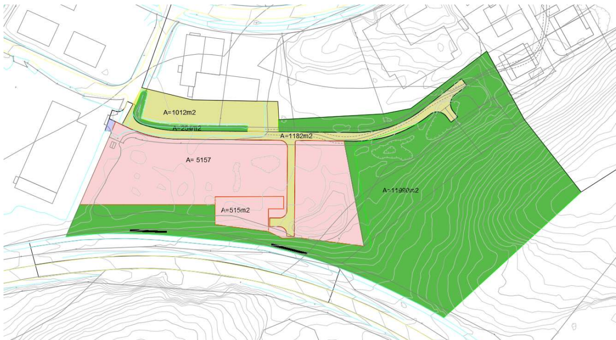
Figur 7 Lokalt nedbørfelt, etter utbygging.
